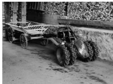
Motrac MKD, 7 PS, den Simi Held 1955 anschaffte. Für leichte Transporte wurde ein Leiterwägeli angehängt.
