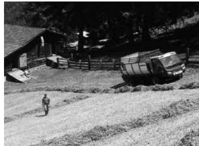
Das neueste und technisch modernste Modell auf dem Markt ist der Aebi Transporter TP 420 mit 4-Radantrieb, 4-Radlenkung und ca. 100 PS. Bild: Luzi Brüesch beim Emden auf Zalaus 2012.
