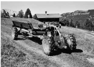
Im Jahr 1958 kam der erste 4-Rad getriebene Motrac MT TTA, 11 PS nach Tschierschen (S. Held). Bereits ein Jahr früher besass Hans Plump-Engel einen JRUS mit 4-Rad Antrieb.
