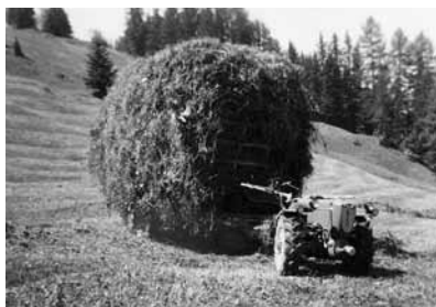
Anfang der sechziger Jahre wurden die Motracs mit Holmenlenkung durch Modelle mit Steuerrad ersetzt. Dies verbesserte die Sicherheit, da die Steuerradlenkung im schwierigen Gelände viel leichter und sicherer war. Bild: im Wichel 1962.
