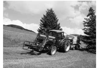
New Holland-Traktor DN 75, 75 PS, Breite 265 cm von Arno Plump. Dieses Modell ist ca. 10 Jahre alt. Foto: Pirigen (Langwies). Der Traktor dient im Lohnbetrieb für die Ballenpresse, als Frontlader sowie für Transporte. Foto: A. Plump.
